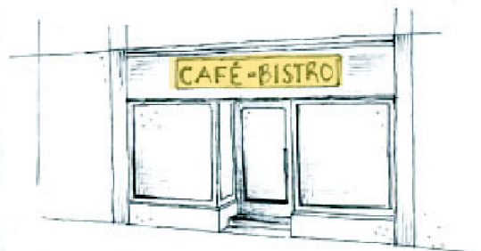
Enseigne posée à plat
